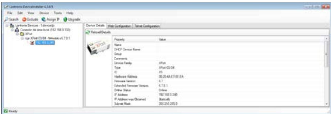
Ahora ya puede cerrar el programa DeviceInstaller.exe y operar con el VHT4510-Ethernet normalmente. Puede repetir estos pasos en un futuro cada vez que desee asignar una nueva dirección IP al dispositivo.
